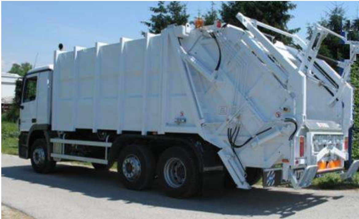
5.2 – es sz. kép: Újrahasznosítható anyagok összegyűjtésére és szállítására szolgáló jármű
