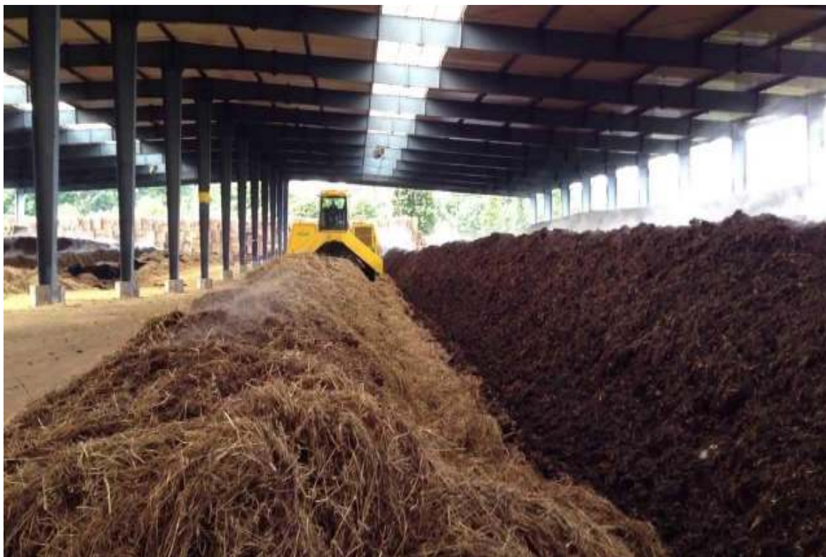
5.5. –ös sz. kép: Példa a zöldhulladék komposztálási folyamatára
