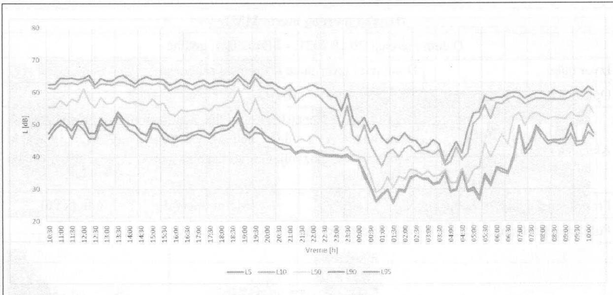
Slika MM1.4. Izmereni procentni nivoi  $L_{A5,15min}$ ,  $L_{A10,15min}$ ,  $L_{A50,15min}$ ,  $L_{A90,15min}$  i  $L_{A95,15min}$
