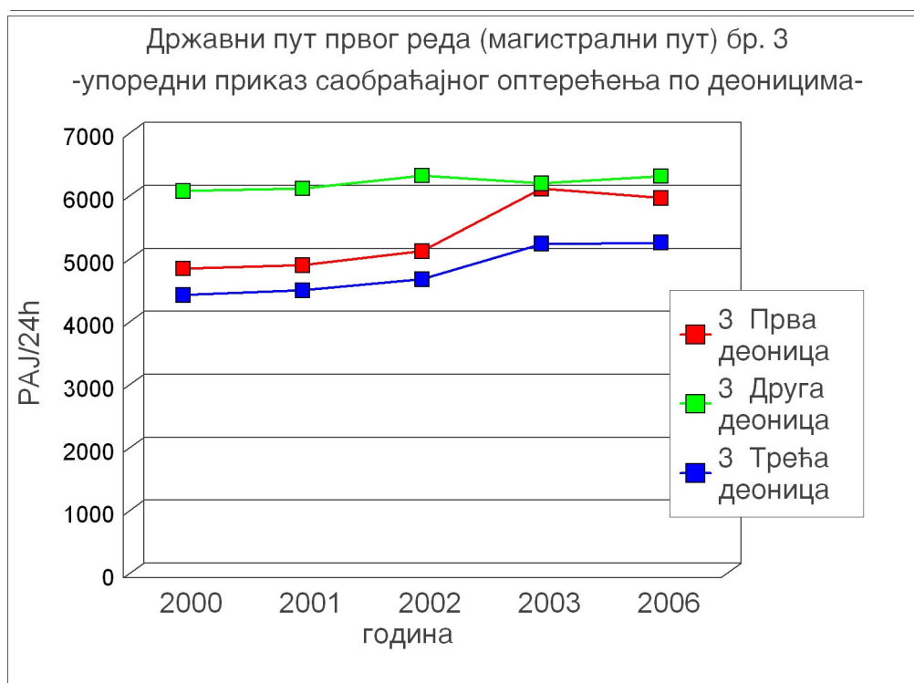
Слика 10. Упоредни приказ саобраћајног оптерећења по деоницама на ДП бр.3
